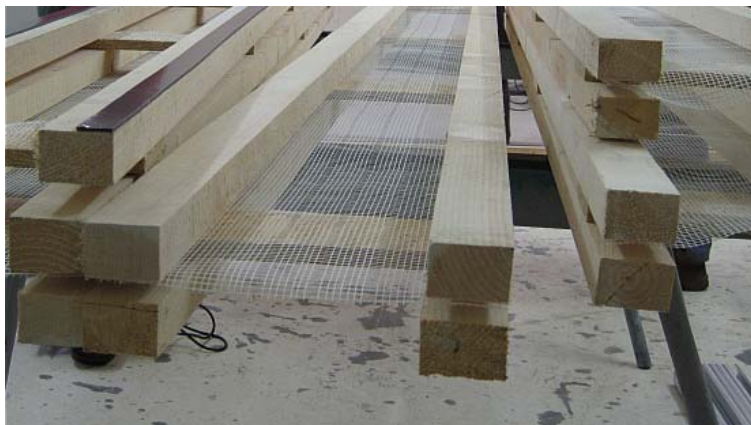
Obr. 1-11: Žebříkový nosník LAG, stojina ze čtyř hranolů 60/40, pásnice z OSB desky tl. 15 mm
