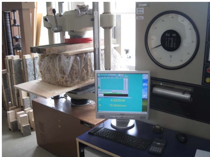
Obr. 6: Průběh tlakové zkoušky a odečítání hodnot deformace při zatížení
