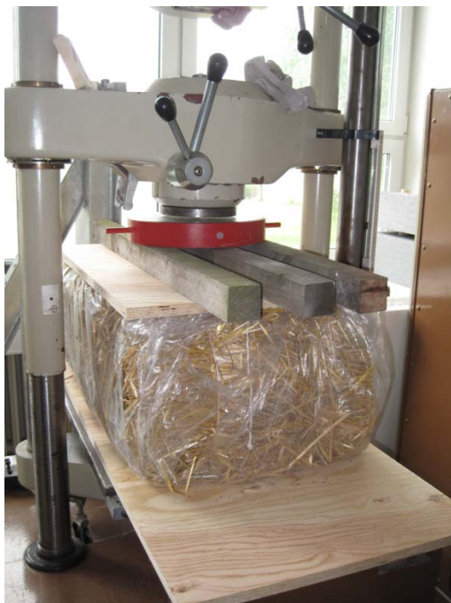
Obr. 5: Slaměný balík v lisu při tlakové zkoušce
