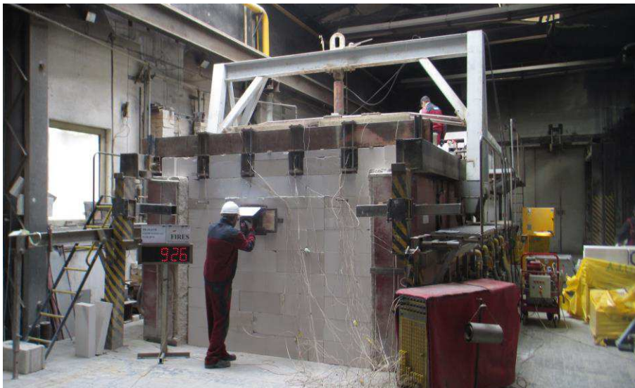
Obrázek 3.: Vodorovná zkušební pec pro zkoušku dle EN 13381-1 včetně stropní konstrukce
