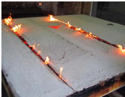
Obr. 4: Panel po požární zkoušce
