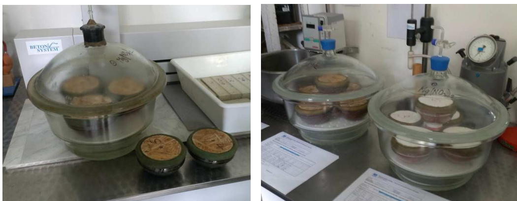
Obr. 3 Zkušební skleněné misky s přírubou a se vzorky s nátěrem latexu a perforací OSB (foto: autor)
